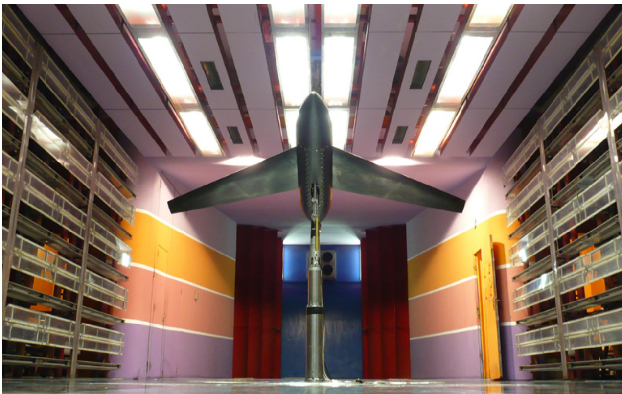
Essais d'une maquette étalon dans la soufflerie S10 de l'IAT-CNAM
